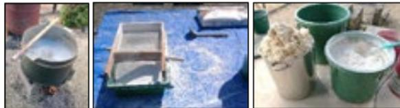
姫路城にも使われた高知産消石灰を主原料に、銀杏草を炊いて糊分を抽出し、長さにこだわった麻スサを大量に使用。素材を自社で集めて製作するので、絶対安心な漆喰です。消石灰を持つ、pH12という高アルカリ性により、漆喰は抗菌性が高く、昔はその調湿性により押入れに塗られていました。また、樹脂に頼らず二酸化炭素CO<sub>2</sub>と化学反応により固まる特徴があります。
